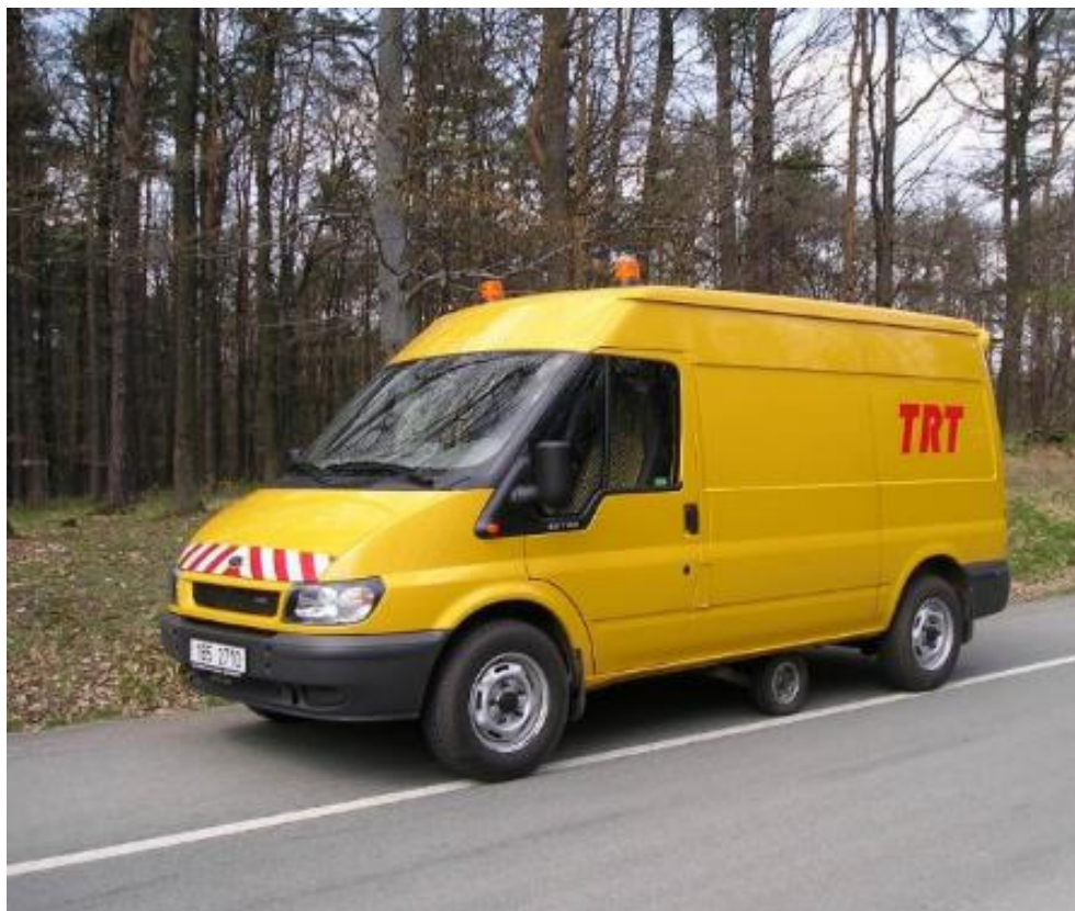
Dynamické měřicí zařízení TRT, které měří součinitel podélného tření f_p , zdroj: Nekula
