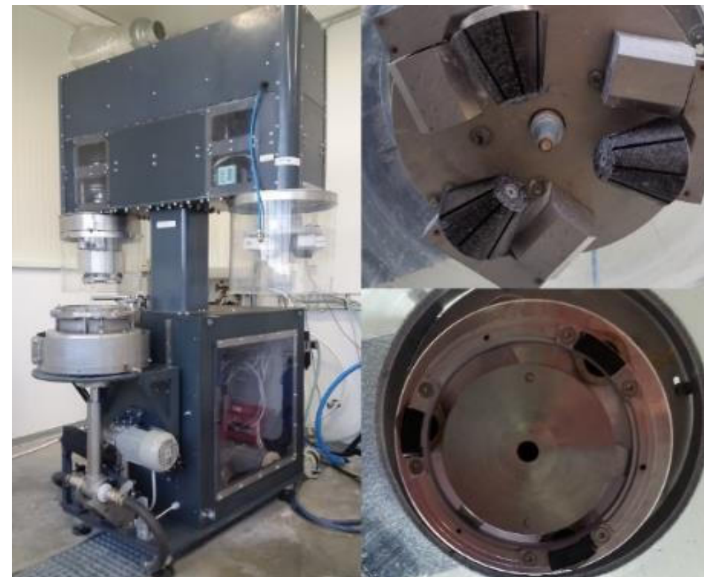
Laboratorní zařízení pro stanovení součinitele tření po ohlazení, celkový pohled - vlevo, ohlazovací hlava - nahoře, měřicí hlava – dole, zdroj: VUT
