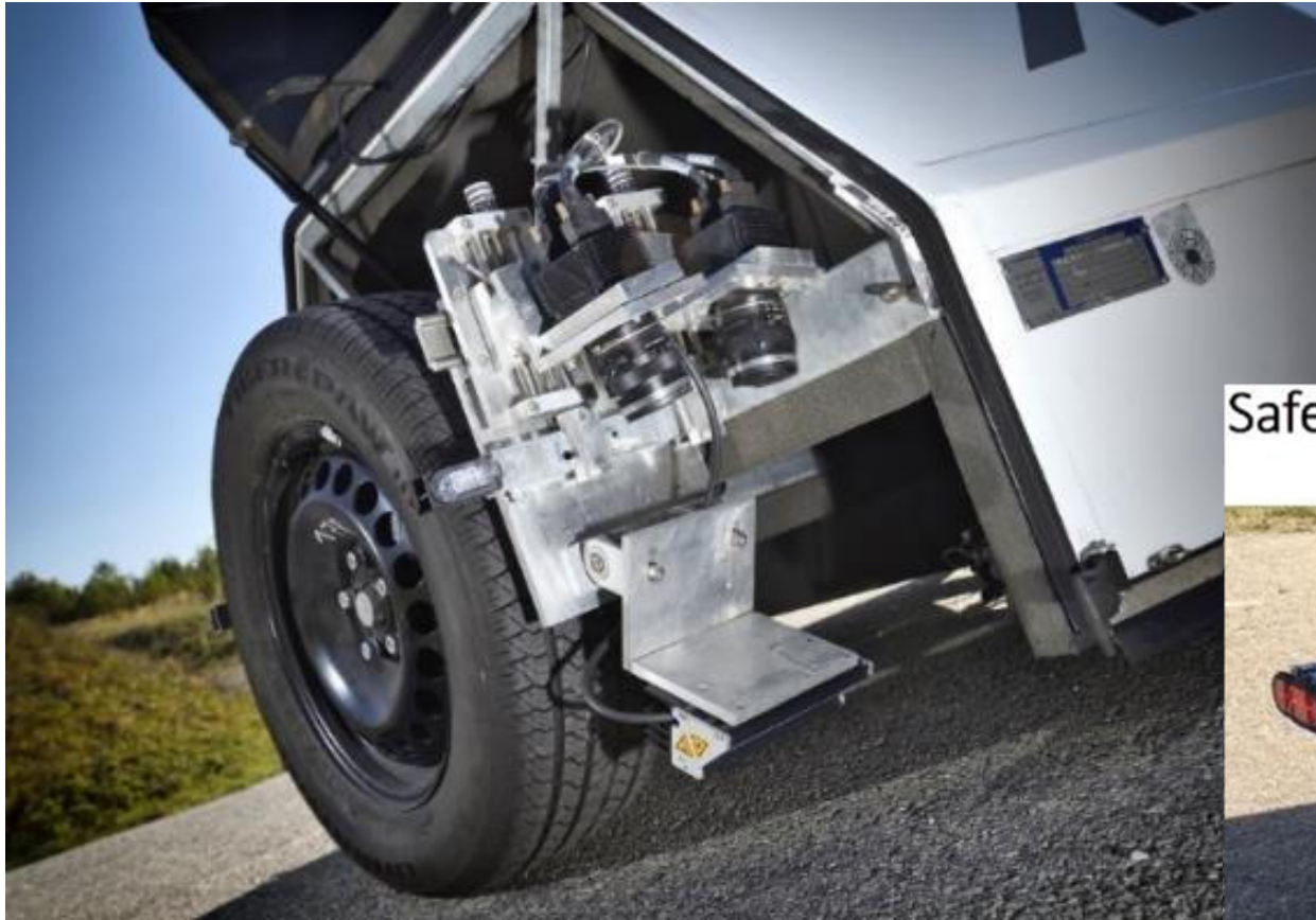
3D road texture scanner, zdroj: AIT fotogrametrie, predikce hlučnosti
