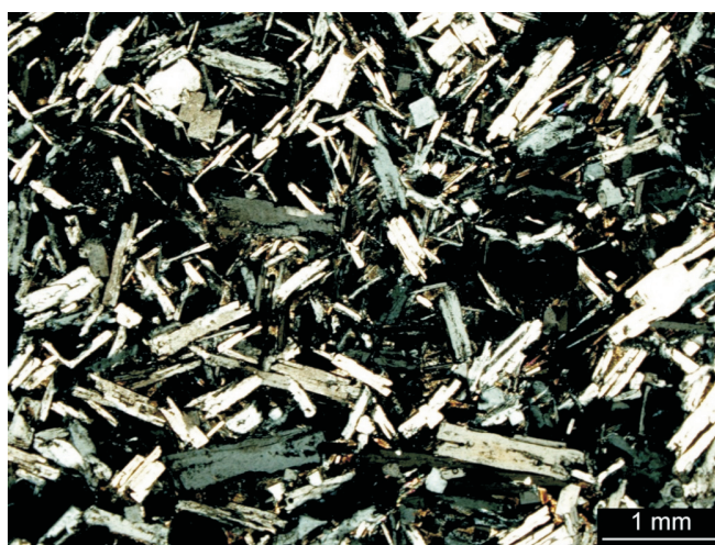
obr. 9.10 Celistvá, krystalická vysokopecní struska (z jádra kusu vysokopecní strusky) bez zjevných známek hydratačních změn. Sonda č. 3, hl. 0,50-0,60 m (IKEA Ostrava). Optická mikroskopie, procházející světlo, zkřížené nikoly. Měřítka na snímku (Foto P. Martinec)
