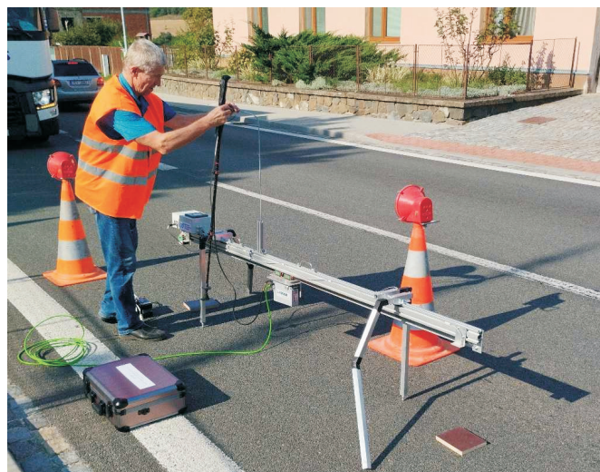
obr. 3 Přenosný rám s automatickým pojezdem osazený laserovým senzorem (zdroj: CDV)
