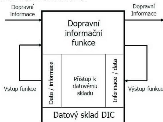
obr. 2 Model dopravního informačního a regulačního členu DS [1]
