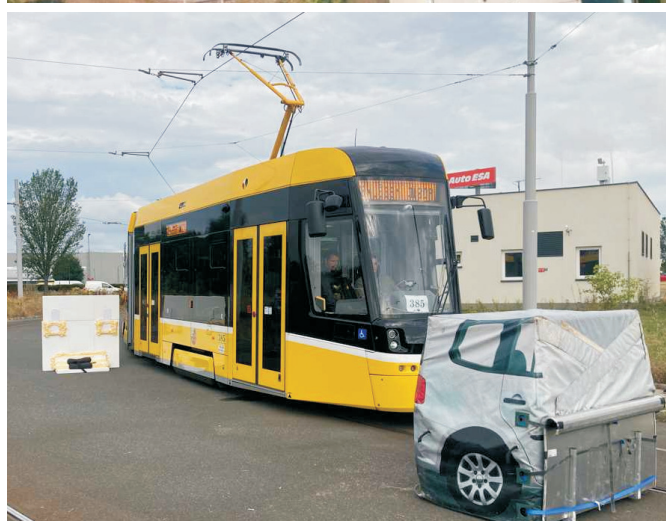
obr. 2 Testování autonomní tramvaje ve smyčce při nižších rychlostech [mapy.cz, vlastní foto]
