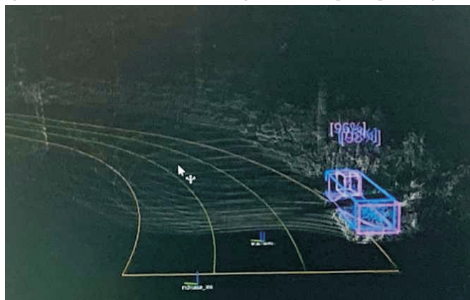
obr. 6a Zobrazení dat z lidarů vozidla
