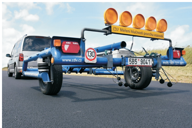
obr. 1 Specializovaný přívěs pro měření hlučnosti povrchu vozovek metodou CPX (zdroj: CDV)
