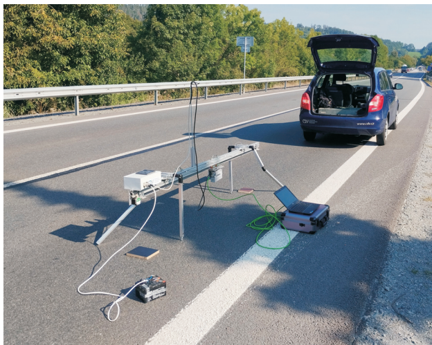
obr. 5 Přenosný rám s automatickým pojezdem osazený laserovým senzorem (zdroj: CDV)
